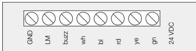
Zum Anschalten des Schallgebers (Option) legen Sie die entsprechende Leitungsader mit Betriebsspannung (je nach Variante: 230 VAC oder 24 VDC) auf die Klemme mit der Bezeichnung „buzz“.
