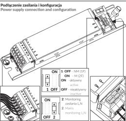
Schemat podłączenia / Schematic diagram
